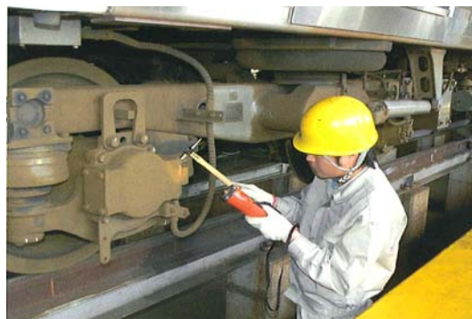
車両の保守点検
