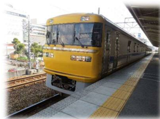
JR東海の軌道・電気総合試験車による検測
