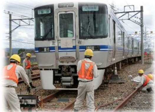
油圧ジャッキによる脱線車両の復旧訓練
