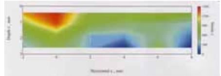
図3 スポット溶接試験片のひずみ分布
