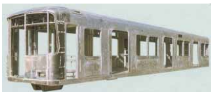
▲大型押出型材で構成したアルミ車体
