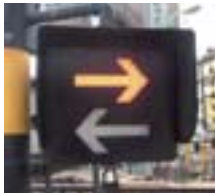
列車進行方向指示器 (LED型) ▶
