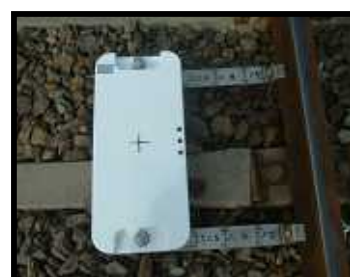
トランスポンダ地上子
