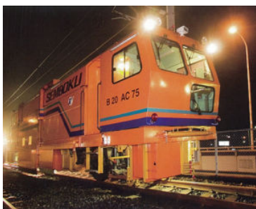
マルチプルタイタンパー コンピューター制御で軌道の狂いを計測して直します。
