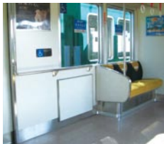
車いすスペース
