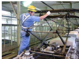
パンタグラフの整備
