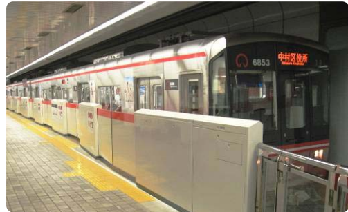
桜通線の可動式ホーム柵
