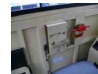
運転席内のハンドスコッチ格納箱に格納されたハンドスコッチと赤色回転警告灯
