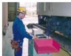
輪重測定装置による管理
