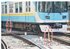
限界支障検知装置
