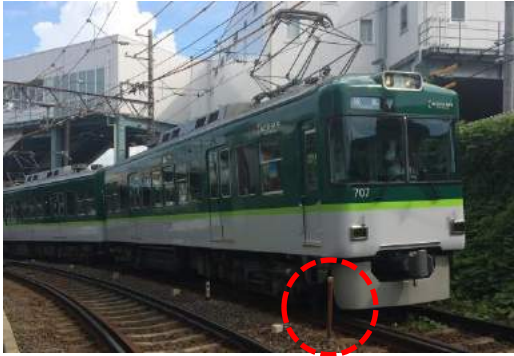
限界支障検知装置
