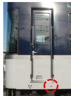
ホーム検知装置
