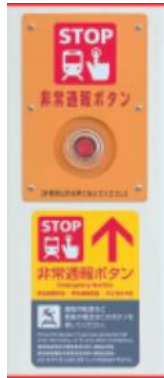
非常通報ボタン
