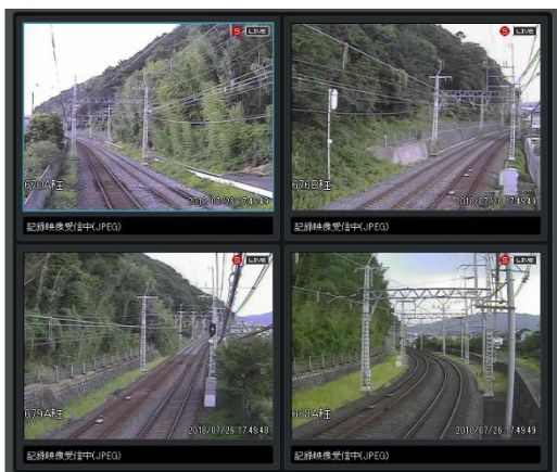
急危険法面監視カメラの映像
