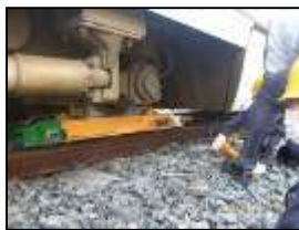
[搬送仮台車設置訓練]
