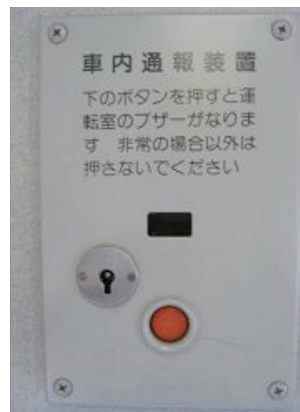
車内通報装置
