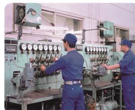
空気ブレーキ装置の試験
