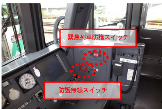
緊急列車防護スイッチと防護無線スイッチ
