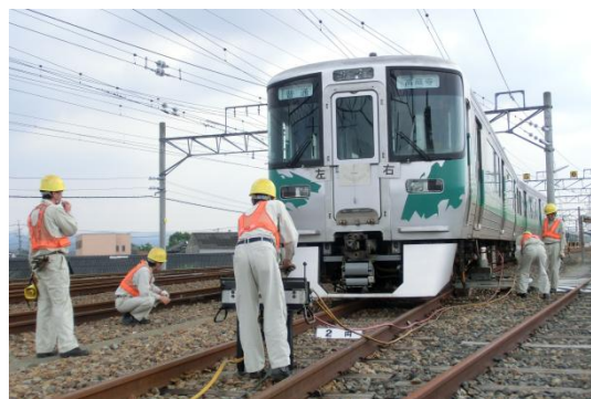
油圧ジャッキによる脱線車両の復旧訓練
