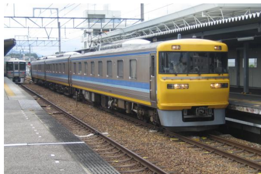
JR東海の軌道・電気総合試験車による検測
