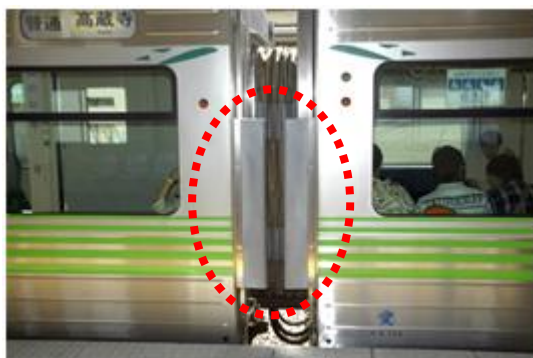
連結面部分に設置した転落防止用幌
