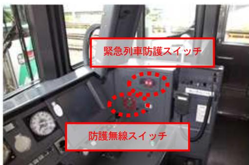
万が一、事故が発生したときは、二次的な事故の発生を防ぐため、付近を走行中の列車を緊急に停止させる必要があります。そのために、列車には、緊急列車防護スイッチ（非常ブレーキ作動・パンタグラフ降下・気笛吹鳴・車両用信号炎管点火・防護無線発報を同時に行う）と防護無線スイッチ（周辺を走行中の列車に無線による緊急停止信号を送るスイッチ）を備え付けています。
