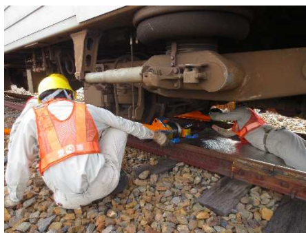
搬送台車の取り付け作業
