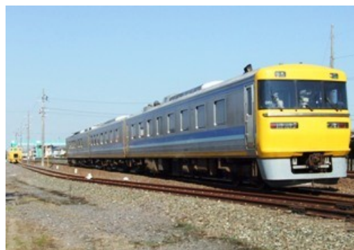
軌道検測車による検測
