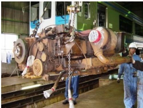
車両の全般検査
