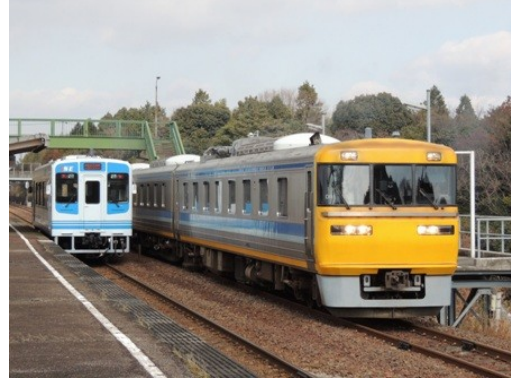
軌道検測車による検測
