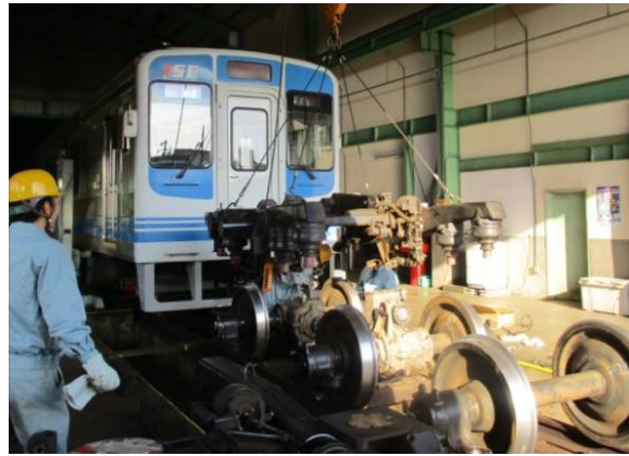
車両重要部検査
