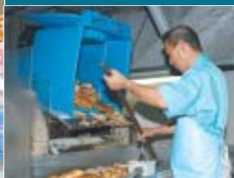
▶ 生ゴミ処理機。 1日の処理量は約1.5トン
