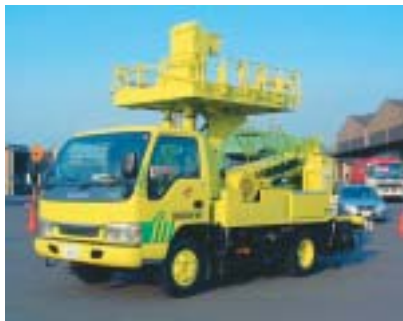
静粛性の高いバッテリーで諸作業を行う、低騒音型架線作業車(軌陸車)
