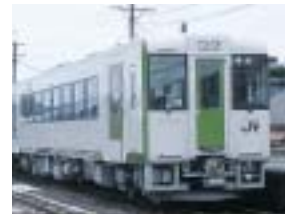
キハ110系 低燃費・低公害エンジンを搭載する在来線用気動車
