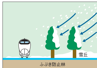
積もった雪が強風で飛ばされ、線路を埋めてしまう地吹雪。この風を弱め、飛んでくる雪から線路を守る防雪林です
