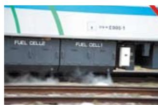
燃料電池ハイブリッド鉄道車両の走行試験
