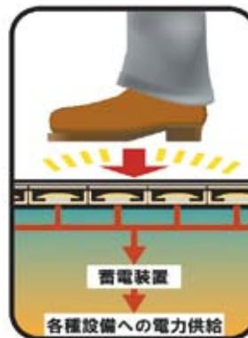
「床発電システム」の仕組み
