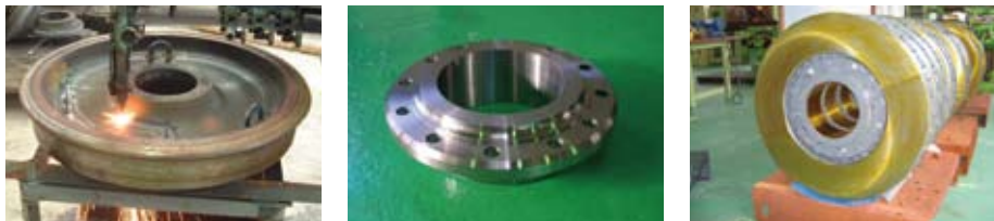
長野総合車両センター 廃車輪をブレーキディスクの部品にリサイクルしています
