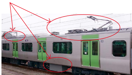
山手線E235系の車上に搭載した電力設備モニタリング
