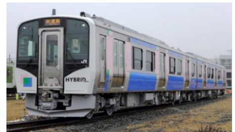
HB-E210系 ディーゼルハイブリッドシステムを搭載した車両
