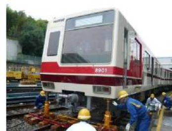
列車脱線復旧
