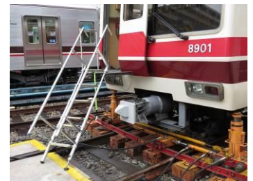
脱線復旧機材習熟訓練
