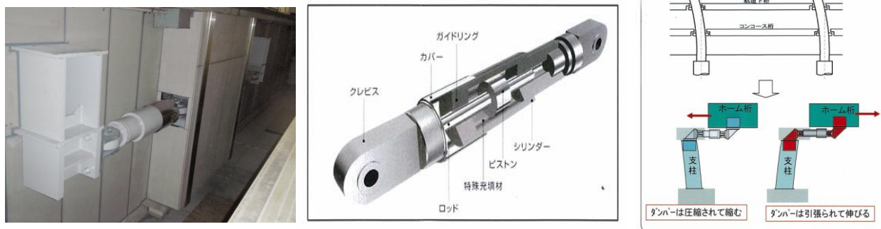
駅舎耐震補強工事・・・支柱とホーム桁をダンパーで連結し、駅舎の耐震を図る。
