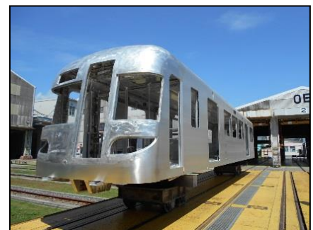
ダブルスキン・アルミ構造車体
