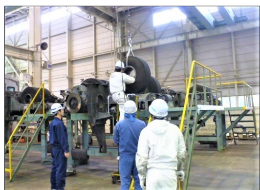
(検査の様子③) 台車からタイヤを分離
