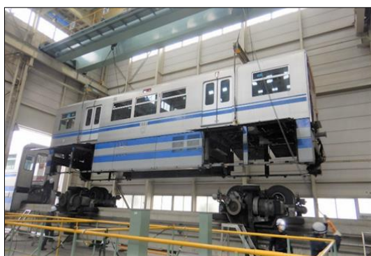
(検査の様子①) 車体と台車を分離
