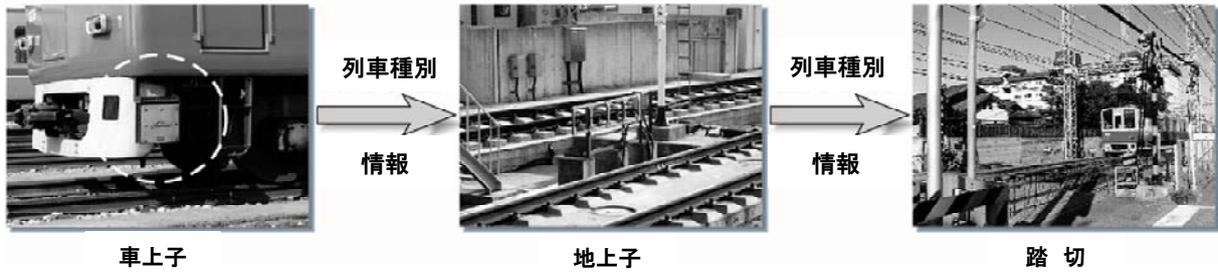
運転士が運転台に設置された設定器で列車種別を設定すると、その情報は車上子(車上アンテナ)に伝えられます。
