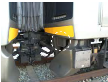
【破線内が転落防止放送装置】
