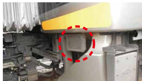
破線内が転落防止放送装置
