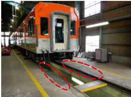
破線内がひずみゲージ設置箇所
