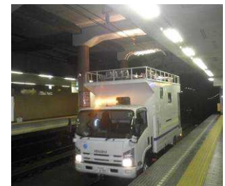
架線検測車による摩耗測定
