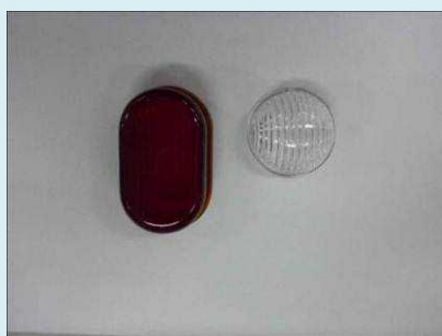
(左) 大型化した車側灯のランプカバー (右) 従来の子ランプカバー
