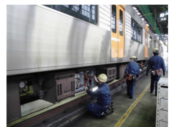
状態・機能検査(月検査)
