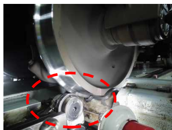
車輪を削正している箇所
