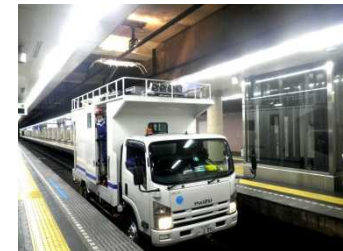
架線検測車による摩耗測定
