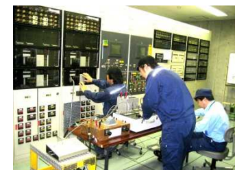
保護継電器特性試験
