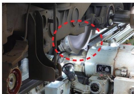
車輪を削正している箇所
