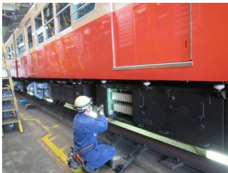
状態・機能検査(月検査)
