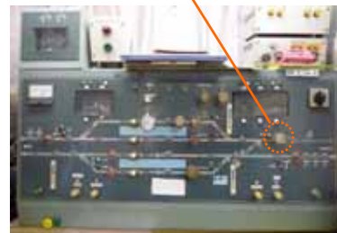
信号を制御する連動装置
