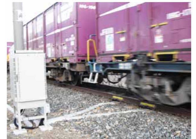
走行中の貨車の輪重比を測定する輪重測定装置
