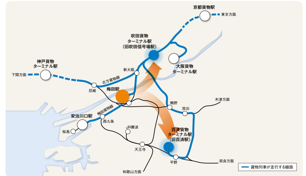
百済駅は、コンテナホーム拡張を行い26両（1,300トン）編成列車に対応できるように改良し、上下12本を増発して、上下18本が発着します。トップリフターを新規に導入することで、大型コンテナの取扱いも可能となり、大阪臨海地区・大阪南地区のご利用の利便性が向上します。
