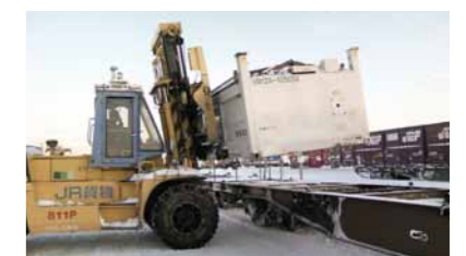
セメント資源になる焼却灰(札幌貨物ターミナル駅)
