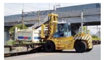
下水道汚泥用コンテナの貨車への積載
