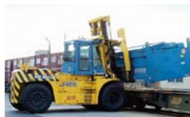
焼却灰用コンテナの貨車への積み込み
