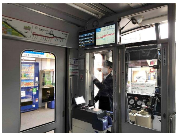
運転台後方に遮蔽シート設置
