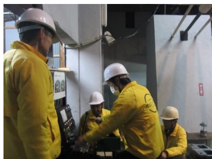
八幡山ロープウェー索道安全ミーティング（予備原動機操作訓練、各種マニュアルの再確認）
